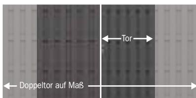
**JUMBO WPC Tore** bestehen aus eloxierten Metallrahmen mit einer Verkleidung aus WPC Profilen. Sie beinhalten den Beschlagsatz und ein Einsteckschloss mit drehbarer Falle (Anschlag DIN links/rechts möglich). Die passende Drückergarnitur (7) erhalten Sie separat. Die Tore sind bereits werksseitig mit der Alu-Aufsatzleiste versehen.
